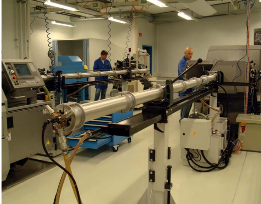
Sui grandi torni a controllo numerico sono tagliati ruote e pignoni.
