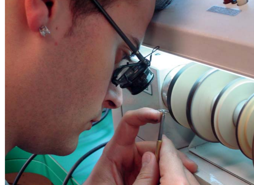
Finitura alla mola della gabbia del tourbillon. Le mole sono in legno, ricoperte di pasta abrasiva.
