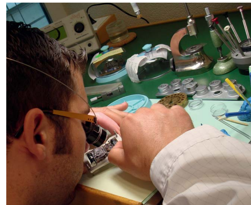
Se tutti conosciamo la Claret per la sua specializzazione nei movimenti meccanici complicati, non bisogna dimenticare che i laboratori sono attrezzati anche per l'assemblaggio di orologi completi. In foto, un momento dell'assemblaggio del calibro del Chapter One di Maîtres du Temps.
